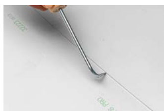
Проверка на шева с тестова игла
