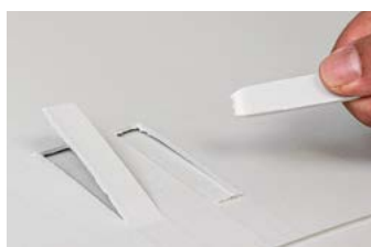
Тест за отлепване (2 cm с откъсване извън фугата)
